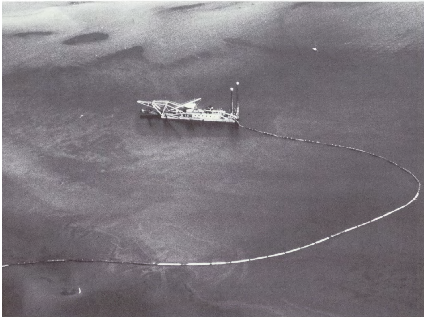
Cuttersugeren TRITON med sin undertiden fem kilometer pumpeledning.
